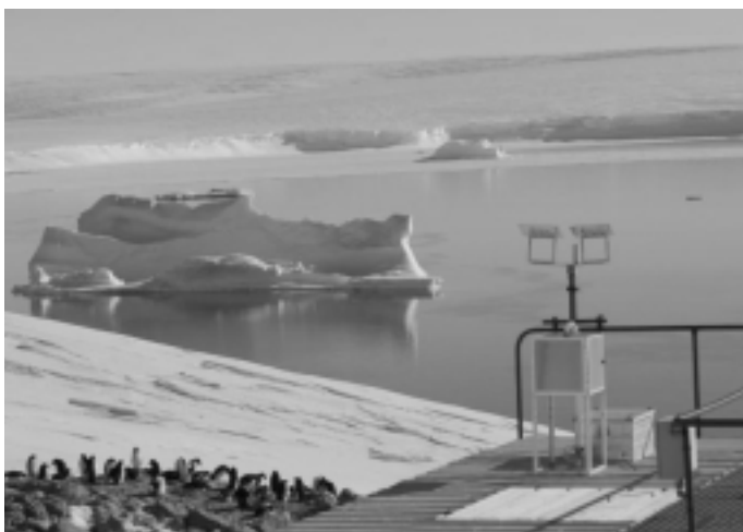
Installation permettant la collecte des particules de l'air sur le site de Dumont d'Urville en Antarctique. © J. Savarino, LGGE.
