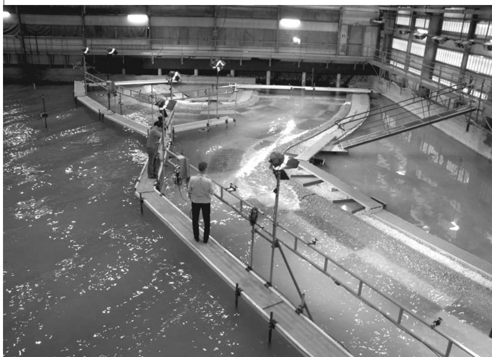
Laboratoire de modèles physiques : aménagement de Palm Deira (Dubai) – Photo : SOGREAH
